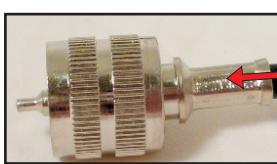
Разъём на конце коаксиального кабеля не имеет резинового наконечника, для предотвращения обрыва при резком изгибе.
